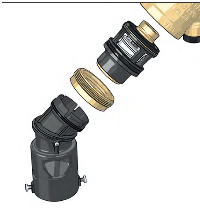
Wymiana wkładu izolatora przepływów zwrotnych
